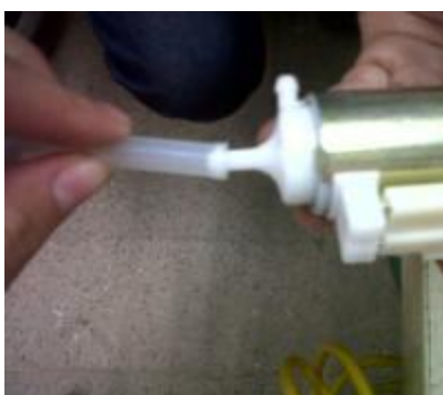
Unión tanque 2- bomba
